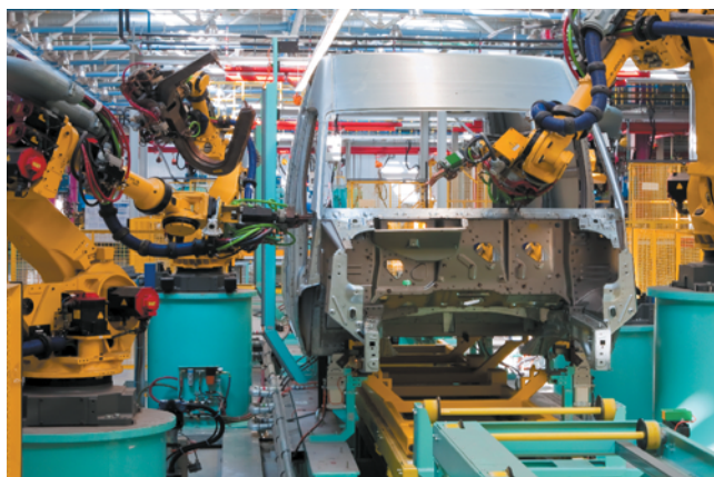
Рис. 1.8. Конвейер по сборке автомобилей промышленными манипуляторами
